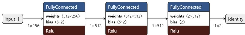
Abbildung 5.15: Modell des erstellten Encoders. Grafik erzeugt mit Neutron[Roent]
