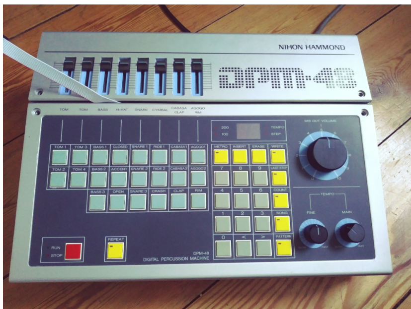
Abbildung 6.6: DPM-48 mit eingebautem MIDI-Interface und ISP-Leitung.
