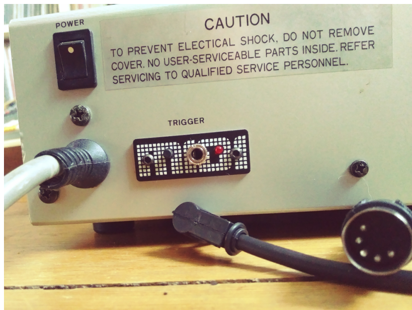
Abbildung 6.3: Eingebautes MIDI/UI-Panel mit TRS-DIN Adapterkabel.
